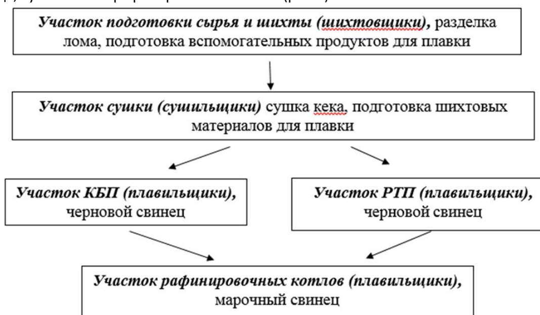
Рис.1. - Структура технологического процесса производства марочного свинца
