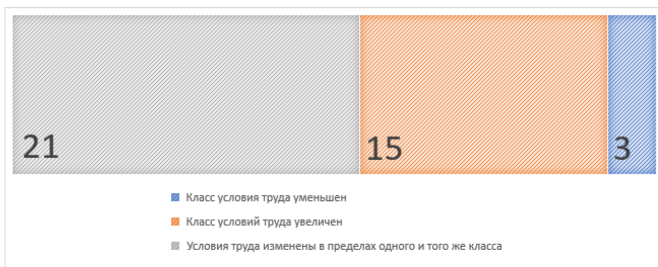
Рисунок 2. Количество рабочих мест с изменением класса условий труда, установленного по результатам СОУТ и ПЛК, после применения персональных шумомеров
