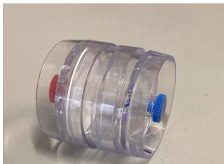
**Рис. 2. Общий вид фильтра Merck Millipore 37 mm**
